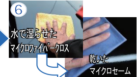
⑥ 最終仕上げは、水で湿らせたマイクロファイバークロスで塗装面を拭き水分が蒸発してくる所を乾いたマイクロセームで乾拭き。
