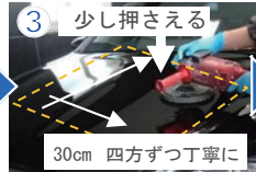
③ 少し押さえる。30cm四方ずつ丁寧に磨いていきます。※工程が進んでいくとパフスポンジ面に研磨成分がたまっていきますので量を調整しながら進んでください。
