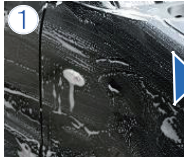
① 土汚れや鉄粉を除去して下さい。水分は拭き上げます。
